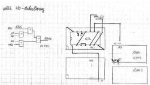
Abhilfe schafft ein DL032, der auch die Adressleitung A5..A7 in die I/O-Dekodierung mit einbezieht. Der Schaltkreis wird huckepack auf A27 angebracht. Die Brücke E2 entfällt.
