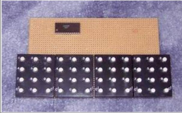
Eine andere Variante kann mit 4 Stück Tastaturen „Pollin 20-420 403“ zu 95 Cent und einem 74x154 aufgebaut werden. Die Tastaturen haben eine 2x7-Matrix, so daß 4 Stück zu einer 4x14-Matrix wie die originale TINY-Tastatur verschaltet werden können.
