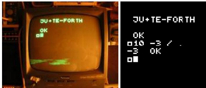
Das JU+TE-FORTH-System setzt das 4K-System ES1988 sowie 8 Kbyte RAM voraus. Das FORTH-System wird von Kassette geladen und lässt sich ab %E000 über PROG oder BASIC starten.
