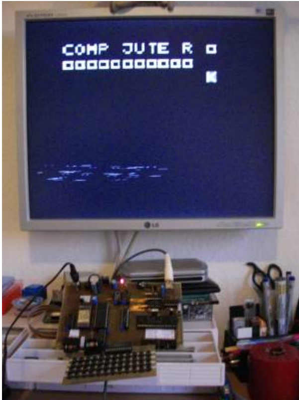
TINY Detail Tastatur, Ansicht von oben, und Test am großen LCD-Bildschirm
