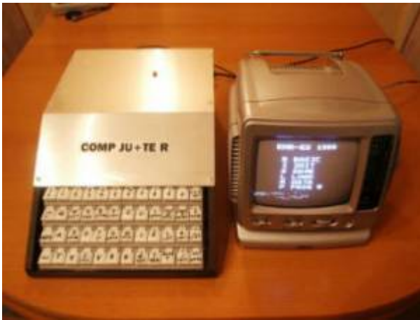
Ein originalgetreuer Nachbau eines TINY von Michael Klopfer. Ich bin beeindruckt vom sehr sauberen Aufbau! Ein Blick unter die Abdeckung: Die Leiterplatten sind handgezeichnet. Sinnvollerweise ist der freie Bereich über den Steckplätzen für die nötigen Anschlüsse genutzt (Video/Tape). Außerdem gibt es eine Spezialkarte vorn mit Tape-Elektronik und dem 2. EPROM.
