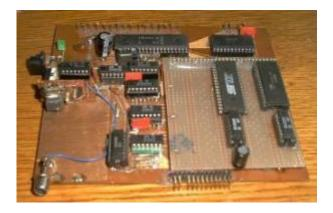
Ein Tiny von M. Radtke. Im Steckplatz 1 ist eine moderne RAM- und ROM-Speicherkarte (waagerecht eingebaut).
