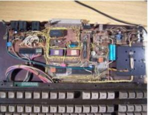
Uwe Nickel: "Entwicklungssystem für Hardwareerweiterungen (emr-es)". Eigentlich ein Standard Ju+Te ergänzt um Bustreiber für alle äußeren Anschlüsse und zwecks effektiver Softwareentwicklung mit ergänztem Betriebssystem (es 3.1).
