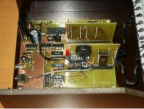
Ein orignalgetreuer Nachbau eines TINY von Michael Klopfer. Ich bin beeindruckt vom sehr sauberen Aufbau! Ein Blick unter die Abdeckung: Die Leiterplatten sind handgezeichnet. Sinnvollerweise ist der freie Bereich über den Steckplätzen für die nötigen Anschlüsse genutzt (Video/Tape). Außerdem gibt es eine Spezialkarte vorn mit Tape-Elektronik und dem 2. EPROM.
