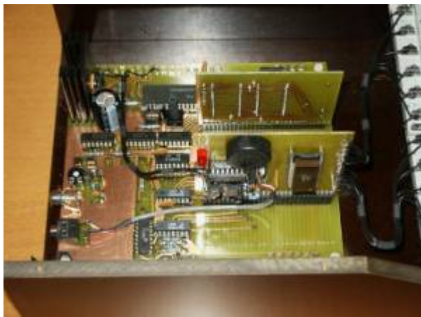
Ein originalgetreuer Nachbau eines TINY von Michael Klopfer. Ich bin beeindruckt vom sehr sauberen Aufbau! Ein Blick unter die Abdeckung: Die Leiterplatten sind handgezeichnet. Sinnvollerweise ist der freie Bereich über den Steckplätzen für die nötigen Anschlüsse genutzt (Video/Tape). Außerdem gibt es eine Spezialkarte vorn mit Tape-Elektronik und dem 2. EPROM.
