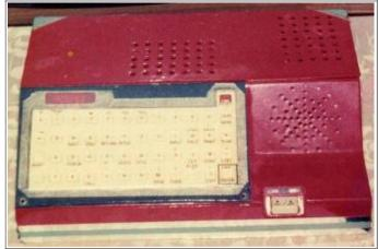
Gehäuse aus Leiterplattenmaterial (Hartpapier), abnehmbare Tastatur aus "geschlachteten" Taschenrechnern beschriftet mit TYPOFIX-Abreibebuchstaben (þberlackiert, klappte erst im 5. Versuch), Netzteil integriert ins Gehäuse, Lautsprecher rechts im Gehäuse, unterhalb des Lautsprecher "progressiver" Ein-/Ausschalter aus einem Kofferradio, Schnittstellen fþr I/O-Ports und Kassette hinten
