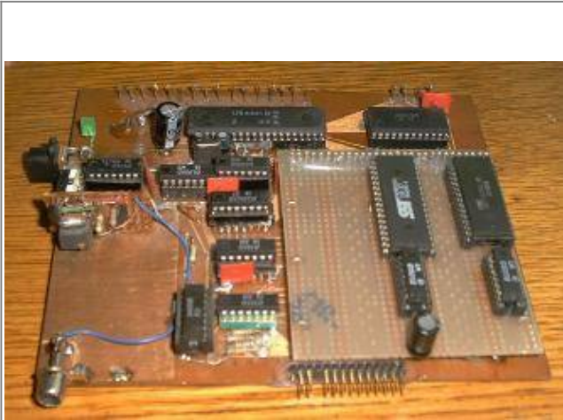
Ein Tiny von M. Radtke . Im Steckplatz 1 ist eine moderne RAM- und ROM-Speicherkarte (waagrecht eingebaut)
