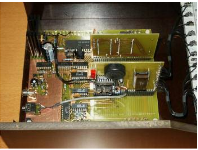
Die Leiterplatten sind handgezeichnet. Sinnvollerweise ist der freie Bereich 1/4ber den Steckplätzen 1/4r die nötigen Anschlüsse genutzt (Video/Tape). Außerdem gibt es eine Spezialkarte vorn mit Tape-Elektronik und dem 2. EPROM.
