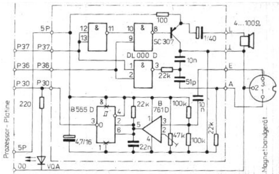
(jmueller:) Das 2K-System verwendet ein hardwaremäßig realisiertes Amplituden-Modulationsverfahren, während das 4K- und 6K-System mit einer softwaremäßig realisierten Frequenzmodulation arbeiten. Deshalb kann man auch die beiden Hardwareschaltungen nicht austauschen, auch wenn sie sehr ähnlich sind.
