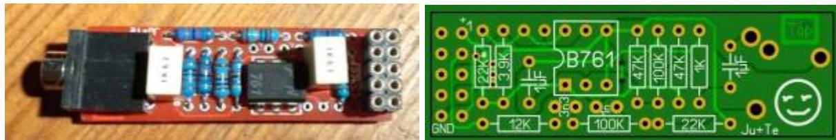
Die am LLC2 und Ju+Te erprobte Schaltung mit geringerem Aufwand und besseren Eigenschaften. Der 8K Widerstand ist entgegen den Vorschlägen des Herstellers in den Applikationen immer noch zu groß bei dir. Ein 22K wird nur bei den OPVs 711,721 und 731 zur Vorstufenversorgung eingesetzt, die auch auf dieser Leiterplatte eingesetzt werden können bei einem Kollektorwiderstand der Ausgangsstufe von 3,9K.
