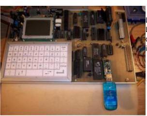
Der Hardwareaufbau zwecks Experimente fand auf Uni-Leiterplatte statt, also gibt es auch kein Leiterplattenlayout. Die in mein bestehendes System, das vollständig auf Uni-Leiterplatte aufgebaut ist, integrierte Erweiterung erfolgte in gleicher Art. (s.Bild)
