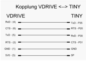
Ursache ist logischerweise der Vollduplex-Datentransfer, den der Vinculum seinerseits macht, während ja der TINY keinen Sende und Empfangspuffer hat (bei der von mir angestrebten UART- und interruptfreien Betriebsweise!).
