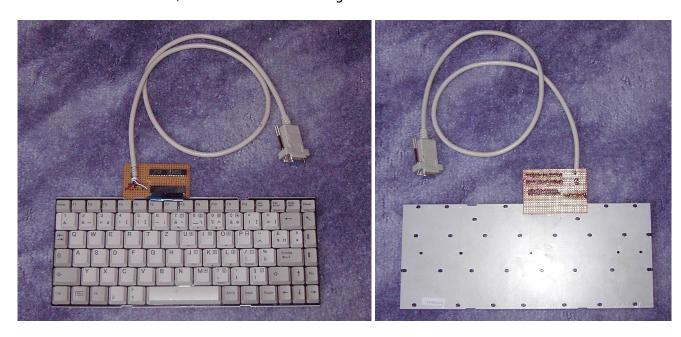
Die Tastatur ist eine 99 Cent-Laptop-Tastatur von Pollin (Bestellnummer 710 010). Angesteuert wird eine  $8\times7$ -Matrix mittels  $74\times257$  und  $74\times138$ .
