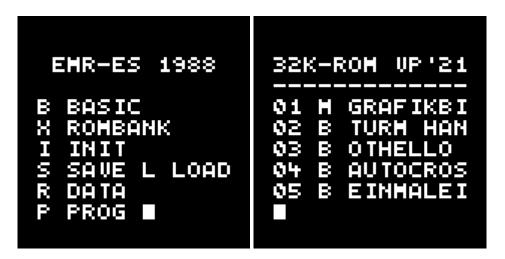
Von den 32K ROM stehen nur 18 kByte zur Verfügung, denn belegt sind 4K vom ES-System und 2K von TINY-BASIC, und der Bereich 6000h-7FFFh wird vom Adressbereich der Tastatur belegt. Dennoch konnten über 17 größere Programme (u.a. FORTH und Basic-Erweiterung sowie das Z8671-Basic) im ROM untergebracht werden:
