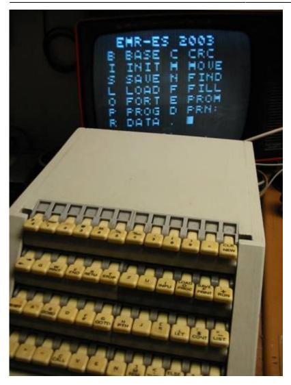
Die Software basiert auf den Floatingpoint-Routinen des ES4.0 (s. ju+te 11/90, S.76 ff). Wenn alles funktioniert, wird es sicher auch die Schaltung und die Software zum Download hier geben.
