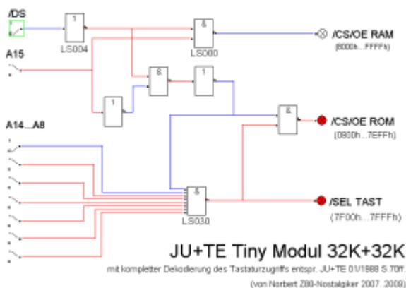
Das ändert sich sofort mit /DS=L, hier wird mit A15=H der RAM ab 8000h eingeblendet und kann benutzt werden.
