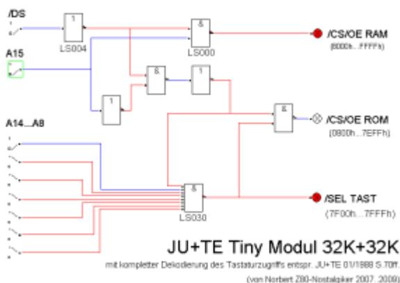
Mit A15=L greifen wir auf den ROM unterhalb 8000h zu, sofern die Tastatursteuerung nicht aktiv ist. Im Original werden A15..A13 zur Bildung des CSB4-Signal (/CS03 - Pin 12 8205) herangezogen:
