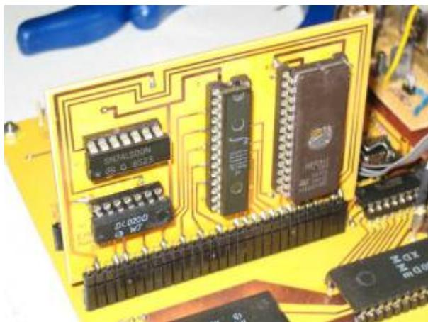
Der überflüssig gewordene DS8205 wird entfernt und neu „verdrahtet“
