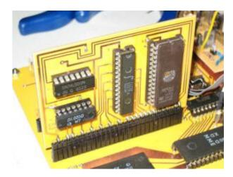
Der überflüssig gewordene DS8205 wird entfernt und neu "verdrahtet"
