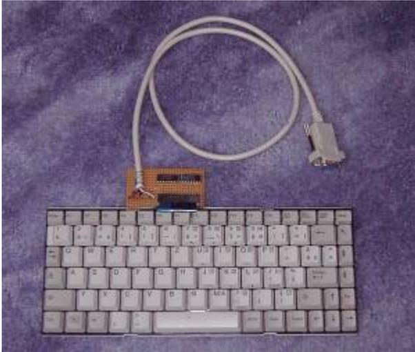
Die Tastatur ist eine 99 Cent-Laptop-Tastatur aus dem Soderangebot von Pollin. Und wie schließt man so eine 8x16-Tastatur sinnvoll an eine 4x15-Matrix an? Angesteuert wird eine 8x7-Matrix mittels 74x257 und 74x138. Details sind in den Unterlagen ausführlich beschrieben und auch auf andere Tastaturen anwendbar. Auf [Mein Tiny](#) gibt es weitere Infos.
