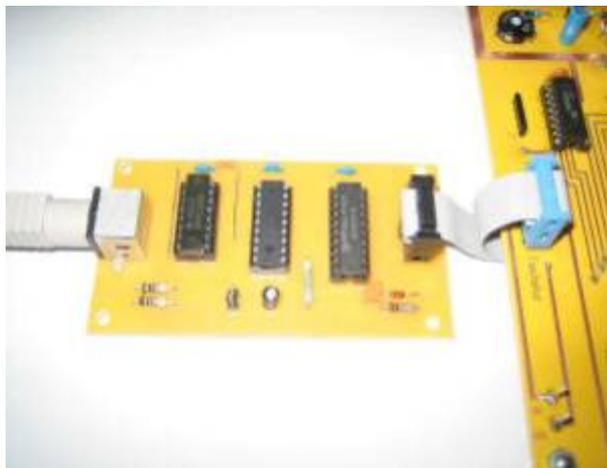
PS2-Adapter für den JU+TE. Der PS2-Adapter arbeitet mit einem kleinen Microcontroller PIC16F628. Das Programm des Controllers setzt die PS2-Tastendrücke in simulierte Tastendrücke der originalen Tastaturmatrix des TINY um, so dass am TINY selbst keine Änderungen nötig sind.
