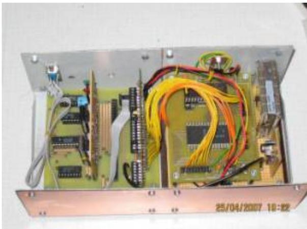
„Ich hatte Anfang 2007 einen JUTE auf Basis eines U884 gebaut (siehe Bild). Er basierte im Wesentlichen auf der von mir bereits im Elektor Sonderheft beschriebenen Rechnerplatine und einem Baugruppenträger. Auf diesem befanden sich Grafikkarte und Steckplätze für 2 Module. Das TINY-Basic und der erste Teil des 4K Betriebssystems saßen im internen ROM-Bereich des U884. Der zweite Teil des BS, zusammen mit 8K dem RAM auf dem ersten Steckplatz.“
