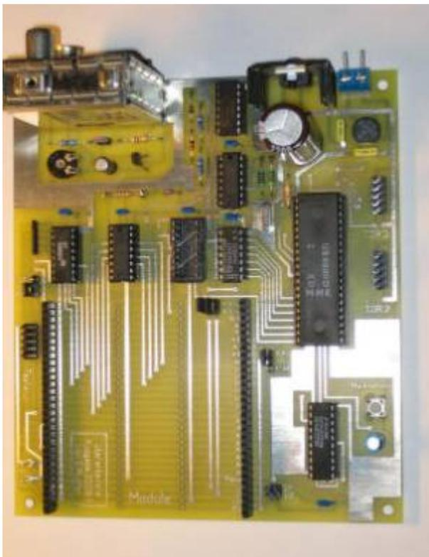
Der „JUTE 2007“ entspricht in Größe und Layout dem originalen TINY. Die Schaltung wurde gegenüber dem Original leicht verändert: Die zwei D195 wurden gegen einen LS165, der DS8212 gegen einen
