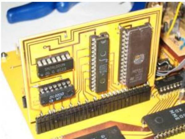
Dieses Modul realisiert den maximalen Speicherausbau für RAM und ROM, der sonst auf 4 Module verteilt ist, in einer Baugruppe.
