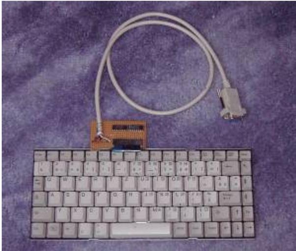
Die Tastatur ist eine 99 Cent-Laptop-Tastatur aus dem Soderangebot von Pollin. Und wie schließt man so eine 8×16-Tastatur sinnvoll an eine 4×15-Matrix an? Angesteuert wird eine 8×7-Matrix mittels 74×257 und 74×138. Details sind in den Unterlagen ausführlich beschrieben und auch auf andere Tastaturen anwendbar. Auf [Mein Tiny](#) gibt es weitere Infos.
