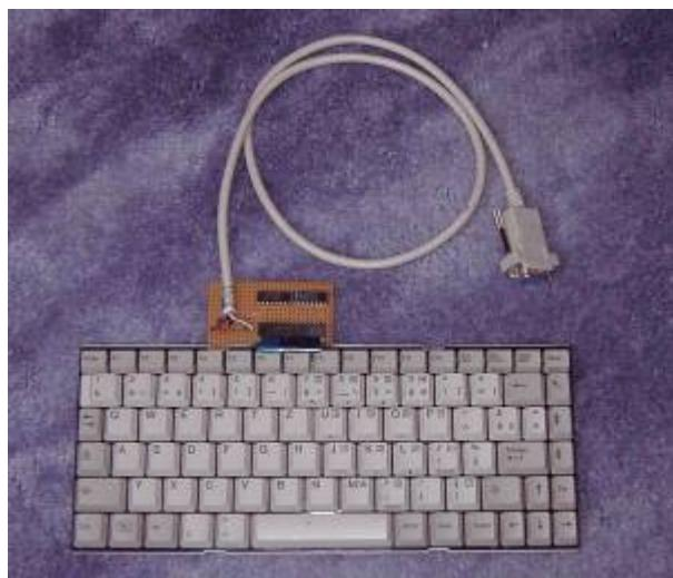
Die Tastatur ist eine 99 Cent-Laptop-Tastatur aus dem Soderangebot von Pollin. Und wie schließt man so eine  $8 \times 16$ -Tastatur sinnvoll an eine  $4 \times 15$ -Matrix an? Angesteuert wird eine  $8 \times 7$ -Matrix mittels  $74 \times 257$  und  $74 \times 138$ . Details sind in den Unterlagen ausführlich beschrieben und auch auf andere Tastaturen anwendbar. Auf [Mein Tiny](#) gibt es weitere Infos.
