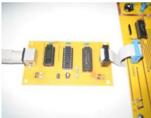
PS2-Adapter für den JU+TE. Der PS2-Adapter arbeitet mit einem kleinen Microcontroller PIC16F628. Das Programm des Controllers setzt die PS2-Tastendrücke in simulierte Tastendrücke der originalen Tastaturnmatrix des TINY um, so dass am TINY selbst keine Änderungen nötig sind.
