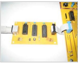
PS2-Adapter für den JU+TE. Der PS2-Adapter arbeitet mit einem kleinen Microcontroller PIC16F628. Das Programm des Controllers setzt die PS2-Tastendrücke in simulierte Tastendrücke der originalen Tastaturmatrix des TINY um, so dass am TINY selbst keine Ã∏nderungen nötig sind.Unterlagen Hinweis: beim PIC muss der Takt auf intern programmiert werden!
