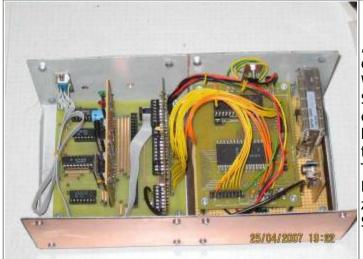
"Ich hatte Anfang 2007 einen JUTE auf Basis eines U884 gebaut (siehe Bild). Er basierte im Wesentlichen auf der von mir bereits im Elektor Sonderheft beschriebenen Rechnerplatine und einem BaugruppentrĤger. Auf diesem befanden sich Grafikkarte und SteckplĤtze für 2 Module. Das TINY-Basic und der erste Teil des 4K Betriebssystems sa̸en im internen ROM-Bereich des U884. Der zweite Teil des BS, zusammen mit 8K dem RAM auf dem ersten Steckplatz."
