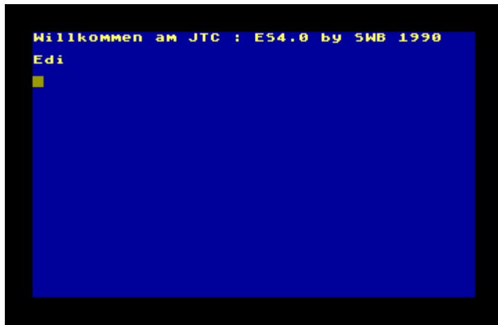
Das Betriebssystem beinhaltet einen BASIC-Editor und einen Maschinenmonitor. Nach dem Einschalten, d.h. nach dem Starten des Emulators, und nach einem RESET meldet sich der BASIC-Editor.
