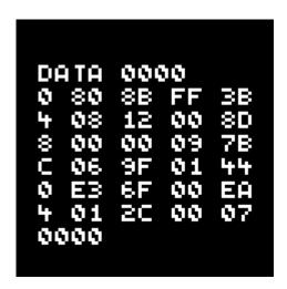
Die DATA-Funktion, die Sie mit der Taste R erreichen, dient zum manuellen Beschreiben von Speicherbereichen. Es werden 24 Bytes des Speichers und darunter die aktuellen Adresse angezeigt. Nach Drücken von jeweils zwei Hexadezimalziffern wird das so eingegebene Byte in den Arbeitsspeicher geschrieben und die Anzeige aktualisiert.
