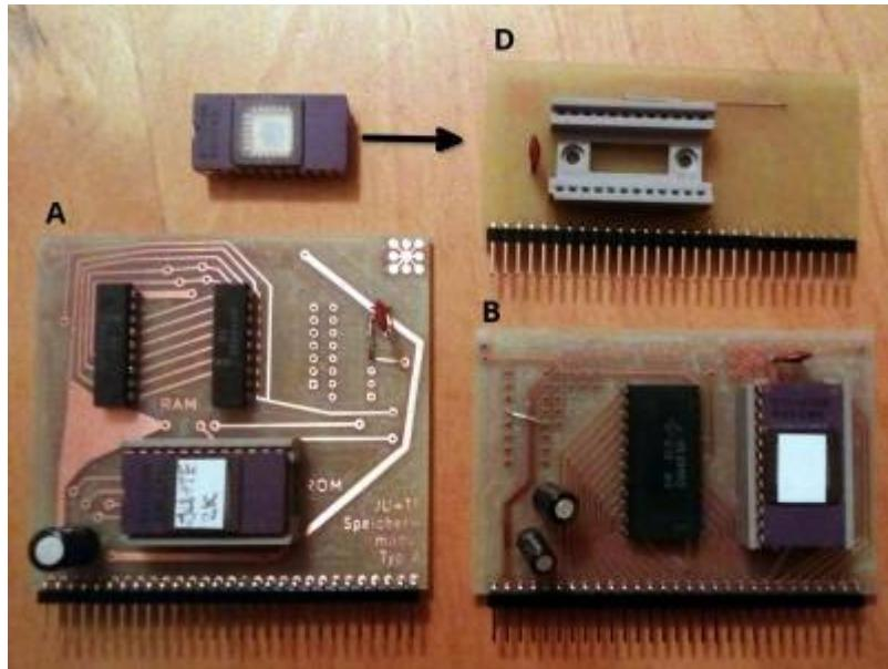
Speichermodule für Tiny Ausbaustufe I, A (1k+1k) und B (2k+2k) funktionieren einwandfrei.
