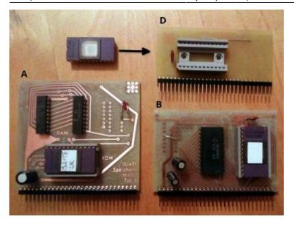
Speichermodule für Tiny Ausbaustufe I, A (1k+1k) und B (2k+2k) funktionieren einwandfrei. D ist das Erweiterungsmodul für Ausbaustufe II
