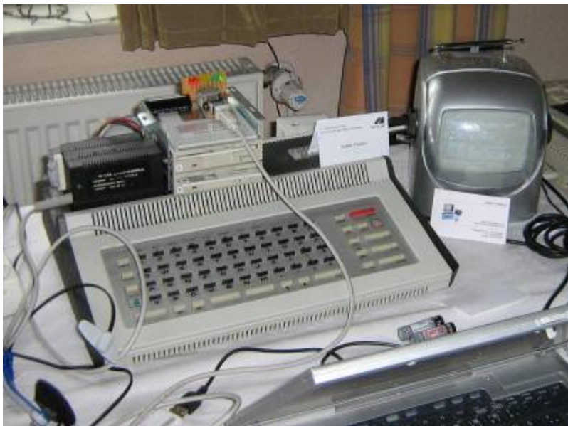
Mein kleiner Stand: Z9001 mit Spracheingabemodul, 2 Stück 3.5"-Diskettenlaufwerken und Miniatur-S/W-Fernseher.
