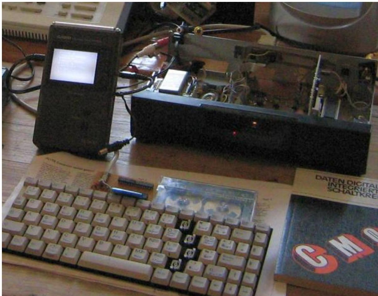
Mein TINY, eingebaut in ein altes Satelliten-Receiver-Gehäuse und mit Laptop-Tastatur
