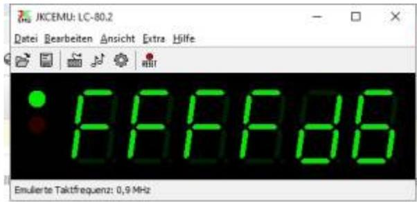
Ändert man den Wert in 2008 auf 0f und startet das Programm, so wird nach jedem Befehl die Anzeige angehalten. Weiter geht es mit beliebiger Taste. Da die Schleife 2 Befehle umfasst, muss man 2x Taste drücken, ehe der angezeigte Wert hochzählt.
