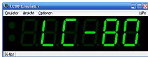
In KCEMU ist die LC 80-Emulation mit kcemu -8 erreichbar. Die LC 80-Emulation unterstützt Tonausgabe (Version 3.8 nicht unter Windows) und erweiterten Speicherausbau (Module RAM2400, RAM2800, RAM3000, RAM4000, RAM8000). Emuliert wird die 2x1K-Version.
