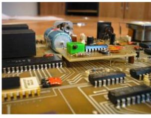
Tastatur und Anzeige, Tastatur Rückseite, geänderte Takterzeugung
