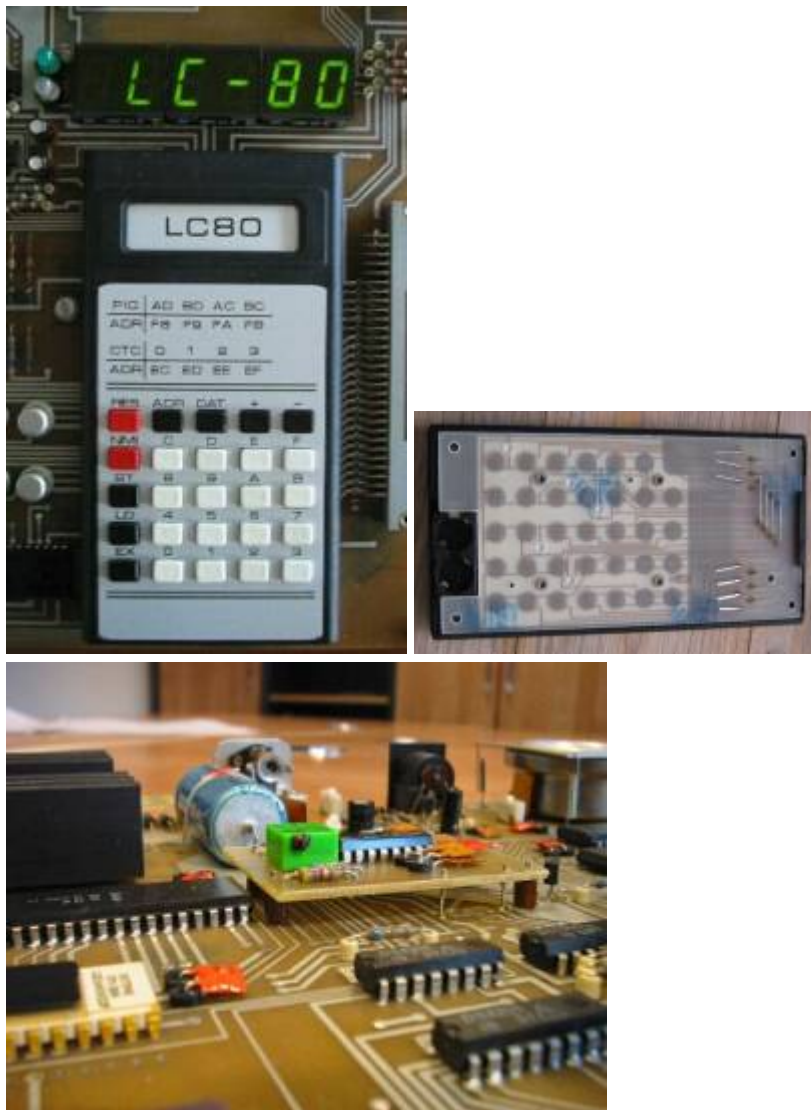
Tastatur und Anzeige, Tastatur Rückseite, geänderte Takterzeugung
