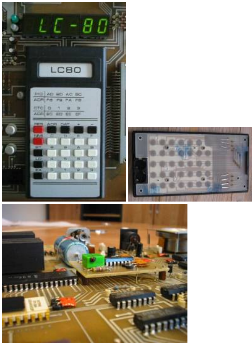
Tastatur und Anzeige, Tastatur Rückseite, geänderte Takterzeugung
