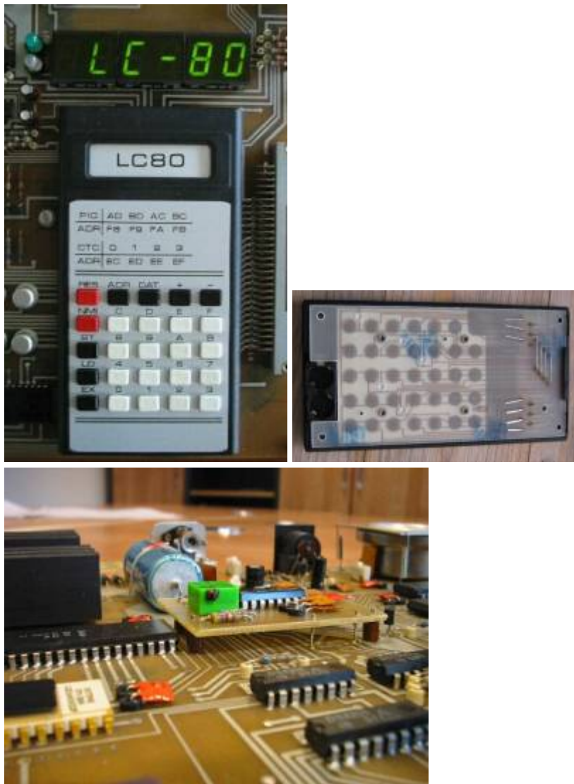
Tastatur und Anzeige, Tastatur Rückseite, geänderte Takterzeugung
