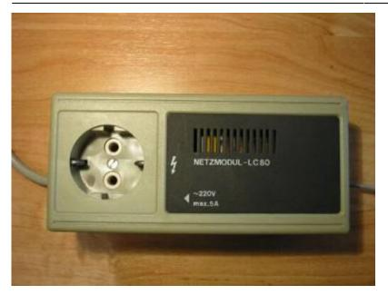
Das Netzteil enthält nur einen Trafo und liefert ca 10V Wechselspannung. Zusätzlich ist eine Schuko-Steckdose ins Netzteil integriert, an der man z.B. den Kassettenrekorder zum Datenspeichern anschließen konnte.
