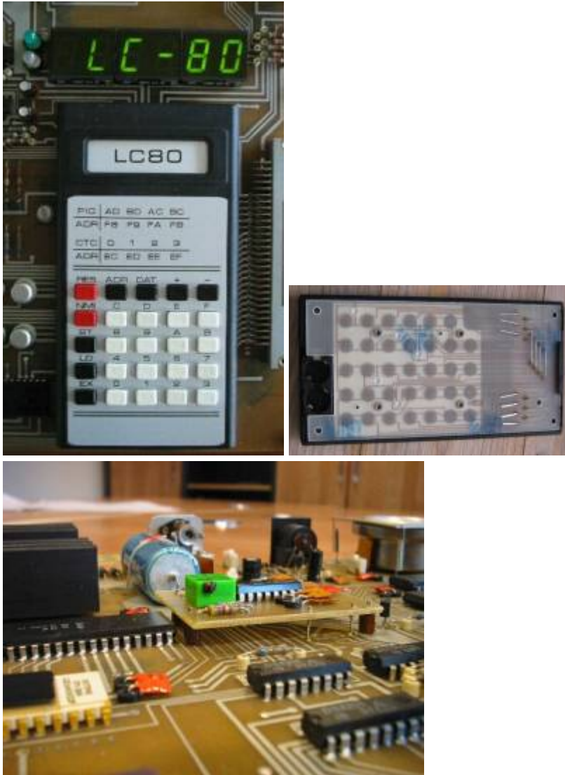
Tastatur und Anzeige, Tastatur Rückseite, geänderte Takterzeugung
