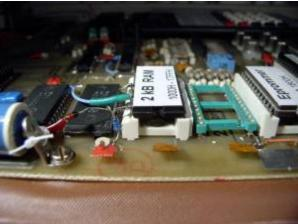
Schaltung der Batteriepufferung und Detailfoto vom Aufbau
