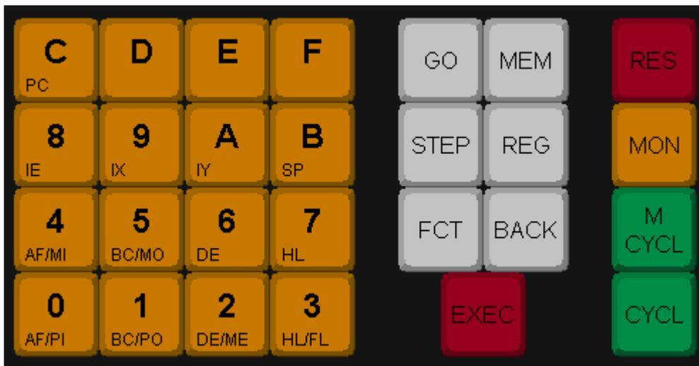
Auf den Zifferntasten stehen die zugehörigen Register für die Registeranzeige. Bei den Zifferntasten 0..5 steht außerdem das Funktionskürzel für die Funktionstaste.
