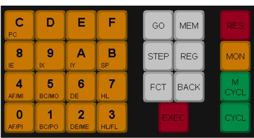
Auf den Zifferntasten stehen die zugehörigen Register für die Registeranzeige. Bei den Zifferntasten 0..5 steht außerdem das Funktionskürzel für die Funktionstaste.
