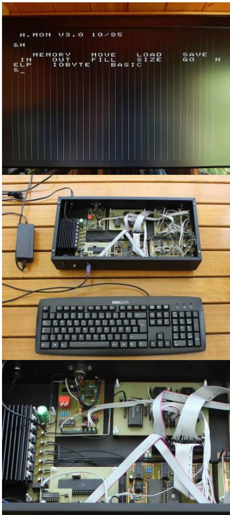
v.l.o.n.r.u. Kassetteninterface, Ein-Ausgabe-Baugruppe, Speicherbaugruppe, Tastaturankopplung, CPU-Baugruppe, Videosteuerung mit Taktgenerator
