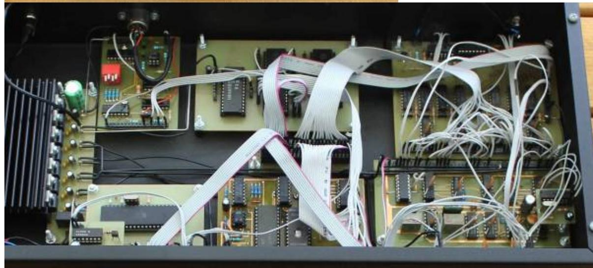
v.l.o.n.r.u. Kassetteninterface, Ein-Ausgabe-Baugruppe, Speicherbaugruppe, Tastaturankopplung, CPU-Baugruppe, Videosteuerung mit Taktgenerator. Nicht im Bild zu sehen ist die Speichersteuerung.
