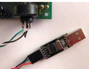
Anschluss an BERT: Serielle Verbindung über die Diodenbuchse; das rote Kabel (+5V) dient zur Stromversorgung über USB
