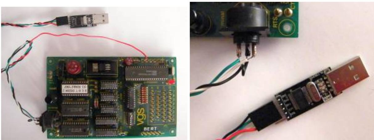
Anschluss an BERT: Serielle Verbindung über die Diodenbuchse; das rote Kabel (+5V) dient zur Stromversorgung über USB
