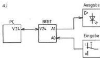
BERT wird über die serielle Schnittstelle mit dem PC verbunden. Die Baudrate wird über die DIP-Schalter ausgewählt (110 bis 19200 Baud). Mit „GO@%1018“ wird der Kommandomodus aktiviert. Über Kommandos wie „A=42“ oder „A?“ werden z.B. Port A beschrieben bzw. abgefragt. Es gibt Kommandos für Porteingabe, Portausgabe, Handshake, Zeitgeber, Analog-Eingabe, Motor-Betrieb, Multiplex, Sonstiges. Das nebenstehende Bild verdeutlicht die Nutzung von BERT als (intelligentes) Interface für den PC
