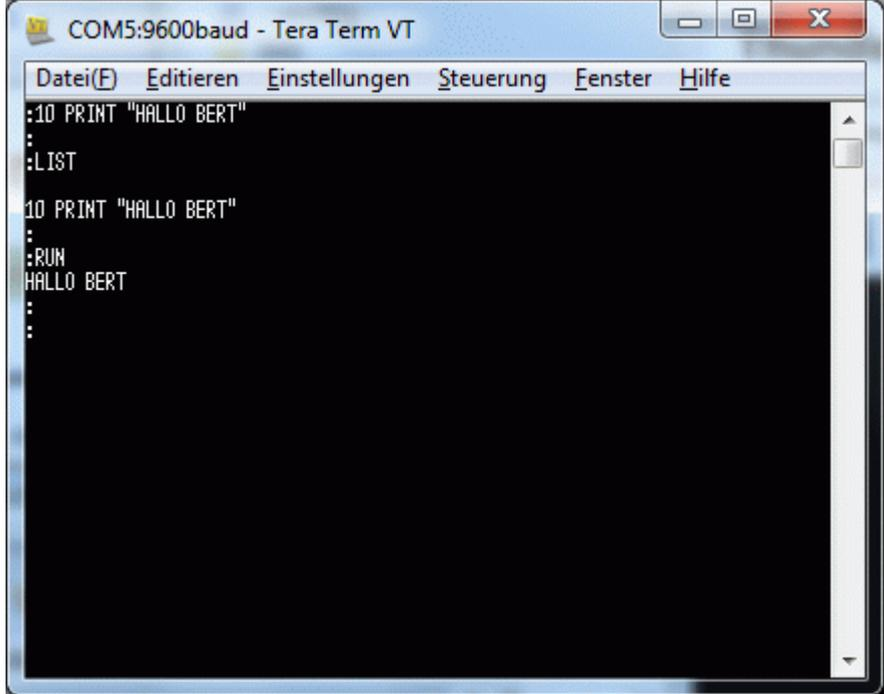
Einstellungen beim Terminal-Programm **TeraTerm**: serieller Anschluss, 9600 Baud; Test mit BASIC/DEBUG
