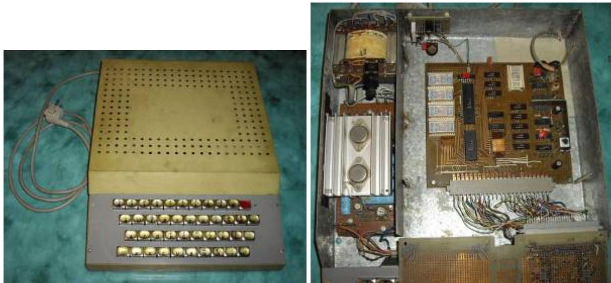
Der BCS3 von Frank Prüfer: Ein stabiles Metallgehäuse und eine vernünftige Tastatur bilden die Basis. Innen sind links das Netzteil, an der Rückwand das Magnetbandmodul und in der Bildmitte die Hauptplatine zu sehen. Nach vorn weggeklappt ist eine 4 KByte-Erweiterung (8 x U214).
