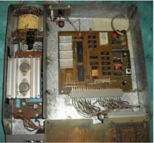
Der BCS3 von Frank Prüfer: Ein stabiles Metallgehäuse und eine vernünftige Tastatur bilden die Basis. Innen sind links das Netzteil, an der Rückwand das Magnetbandmodul und in der Bildmitte die Hauptplatine zu sehen. Nach vorn weggeklappt ist eine 4 KByte-Erweiterung (8 x U214).
