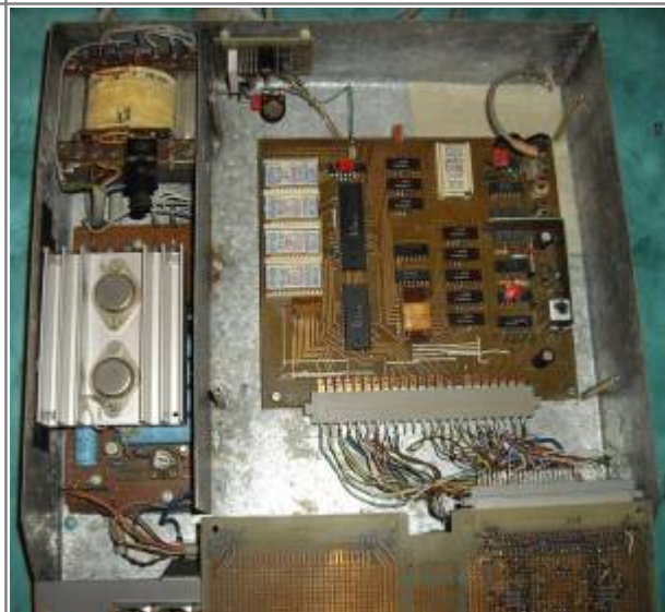
Innen sind links das Netzteil, an der Rückwand das Magnetbandmodul und in der Bildmitte die Hauptplatine zu sehen. Nach vorn weggeklappt ist eine 4 KByte-Erweiterung (8 x U214).
