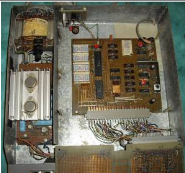
Innen sind links das Netzteil, an der Rückwand das Magnetbandmodul und in der Bildmitte die Hauptplatine zu sehen. Nach vorn weggeklappt ist eine 4 KByte-Erweiterung (8 x U214).
