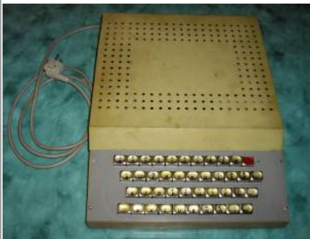
Der BCS 3 von Frank Prüfer . Ein stabiles Metallgehäuse und eine vernünftige Tastatur bilden die Basis.
