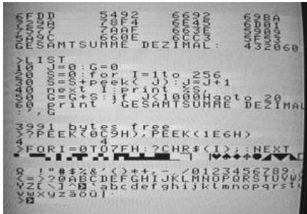
Das System 3.2 von Frank Prüfer in Aktion: Oben die Prüfsummen, darunter das Programm, dann Anzeige des Zeichensatzes.
