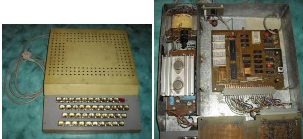
Der BCS3 von Frank Prüfer: Ein stabiles Metallgehäuse und eine vernünftige Tastatur bilden die Basis. Innen sind links das Netzteil, an der Rückwand das Magnetbandmodul und in der Bildmitte die Hauptplatine zu sehen. Nach vorn weggeklappt ist eine 4 KByte-Erweiterung (8 x U214).
