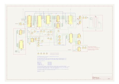
Der Part mit dem D192 für den Speicherimplus ist für das Schieberegister und den SCART-Anschluss. Bei mir läuft es so gut, dass es nun überhaupt keine Flickerei mehr gibt und auch nicht mehr mit der Zeit "wegläuft". Ist auch logisch, da jetzt alles linear vom Systemtakt abgeleitet ist. Bei mir läuft es aktuell mit 7 MHz und 40×24 Zeichen (Änderung im ROM-Code notwendig für 24 Zeilen).
