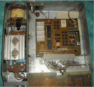
Der BCS3 von Frank Prüfer: Ein stabiles Metallgehäuse und eine vernünftige Tastatur bilden die Basis. Innen sind links das Netzteil, an der Rückwand das Magnetbandmodul und in der Bildmitte die Hauptplatine zu sehen. Nach vorn weggeklappt ist eine 4 KByte-Erweiterung (8 x U214).
