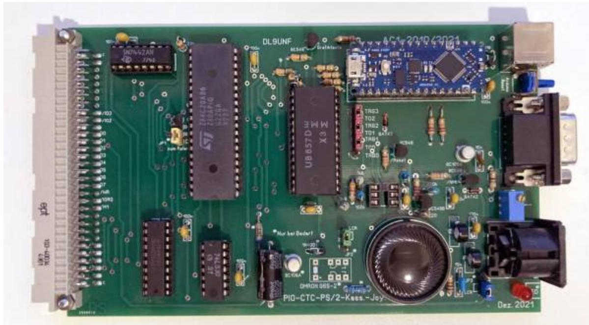
Die I/O-Karte enthält die PIO1 für den Anschluss einer Tastatur und das Kassetteninterface (kompatibel zum Ur-AC1). Als Tastatur kommt eine PS2-Tastatur zum Einsatz. Ein Arduino-Nano übernimmt die Umsetzung der PS2-Daten in ASCII.
