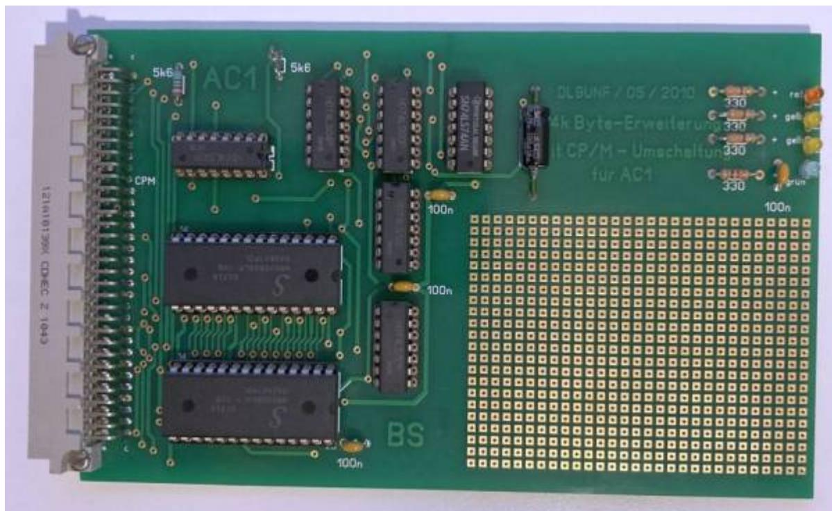
Auf der Karte sind 64 KByte statischer RAM. Der Bereich 0000-1FFF ist normalerweise nicht verfügbar, in diesem Bereich befinden sich auf der CPU-Leiterplatte System-Monitor, 2 KByte RAM und auf der BWS-Karte weitere 2 KByte RAM. Für CP/M-Betrieb kann der komplette RAM ab 0000 eingeschaltet werden; die BWS-Ausgabe erfolgt in diesem Fall durch internes Umschalten auf den BWS-RAM. Die ROM-Karten können durch Signale den RAM deaktivieren.
