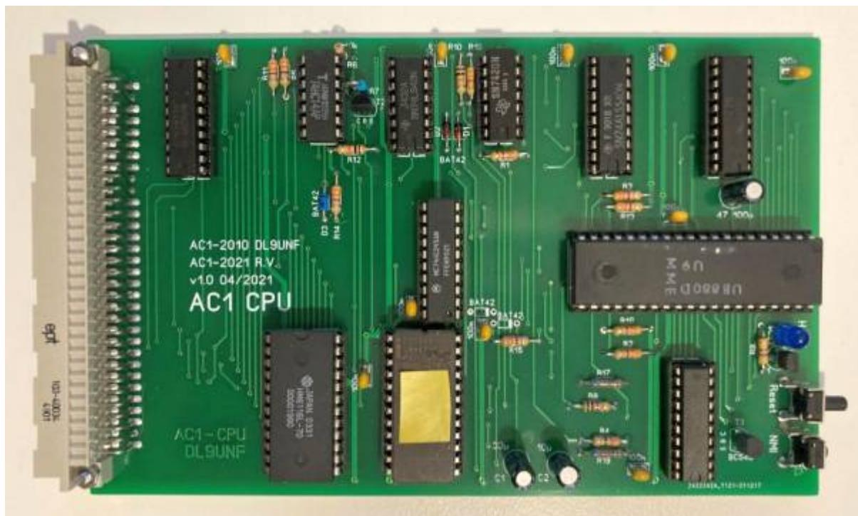
Auf der Karte ist eine CPU U880, der System-Monitor und ein kleiner statischer RAM enthalten. Es gibt Tasten für Reset und NMI.
