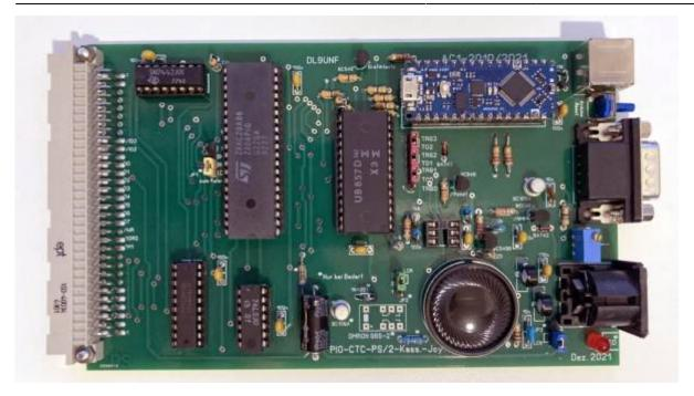
Die I/O-Karte enthält die PIO1 für den Anschluss einer Tastatur und das Kassetteninterface (kompatibel zum Ur-AC1). Als Tastatur kommt eine PS2-Tastatur zum Einsatz. Ein Arduino-Nano übernimmt die Umsetzung der PS2-Daten in ASCII.
