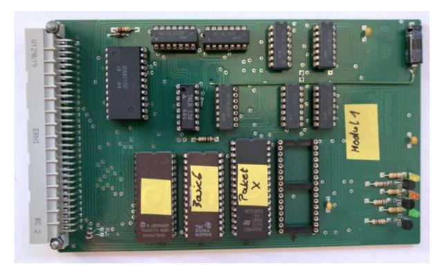
Auf der Karte sind 2 EPROMs und eine 1 MByte-EPROM-Bank. Die EPROMs blenden sich in den Adressraum des Systems ein: Bei Schreibzugriffen im Bereich 0-0FFF wird der "hinter" dem System-ROM liegende, verdeckte RAM der 64K-RAM-Karte beschrieben.
