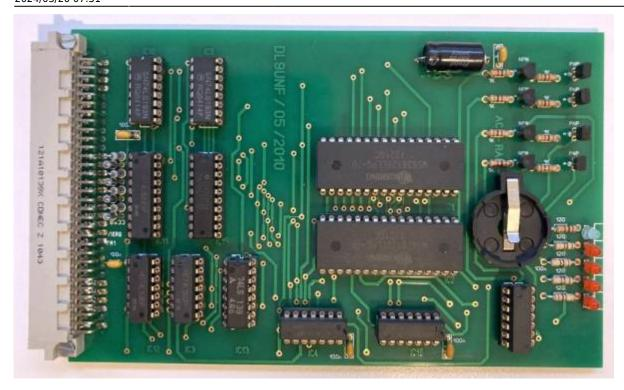
Die eigentliche RAM-Disk wird über IN- und OUT-Befehle bedient und tangiert den Hauptspeicher nicht. Genutzt wird die RAM-Floppy vor allem im CP/M als Laufwerk A:. Im AC1-Modus kann die RAM-Disk mit den Floppy-Routinen von Johann Spannenkrebs verwendet werden. http://www.ac1-info.de/ac1\_2010/fdc/Beschreibung\_FDC\_16.pdf Zur Speicherung von Programmen
