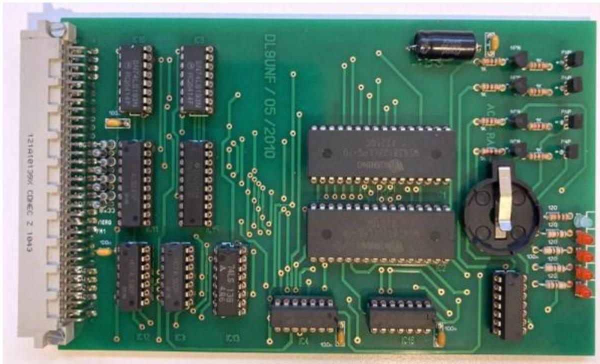
Die eigentliche RAM-Disk wird über IN- und OUT-Befehle bedient und tangiert den Hauptspeicher nicht. Genutzt wird die RAM-Floppy vor allem im CP/M als Laufwerk A:. Im AC1-Modus kann die RAM-Disk mit den Floppy-Routinen von Johann Spannenkrebs verwendet werden.
