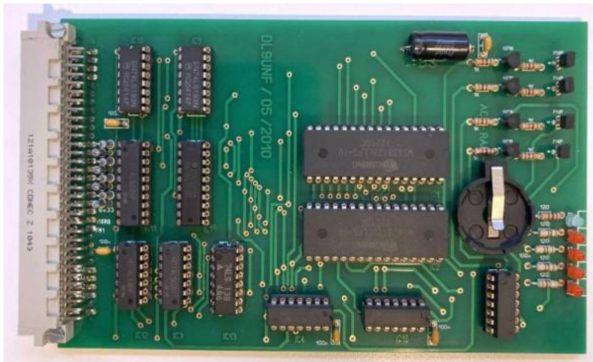
Die eigentliche RAM-Disk wird über IN- und OUT-Befehle bedient und tangiert den Hauptspeicher nicht. Genutzt wird die RAM-Floppy aktuell nur in CP/M.
