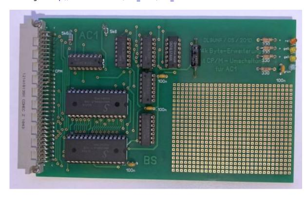
Auf der Karte sind 64 KByte statischer RAM. Der Bereich 0000-1FFF ist normalerweise nicht verfügbar, in diesem Bereich befinden sich auf der CPU-Leiterplatte System-Monitor, 2 KByte RAM und auf der BWS-Karte weitere 2 KByte RAM. Für CP/M-Betrieb kann der komplette RAM ab 0000 eingeschaltet werden; die BWS-Ausgabe erfolgt in diesem Fall durch internes Umschalten auf den BWS-RAM. Die ROM-Karten können durch Signale den RAM deaktivieren.
