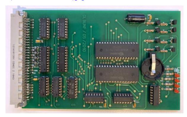
Die eigentliche RAM-Disk wird über IN- und OUT-Befehle bedient und tangiert den Hauptspeicher nicht. Genutzt wird die RAM-Floppy aktuell nur in CP/M.
