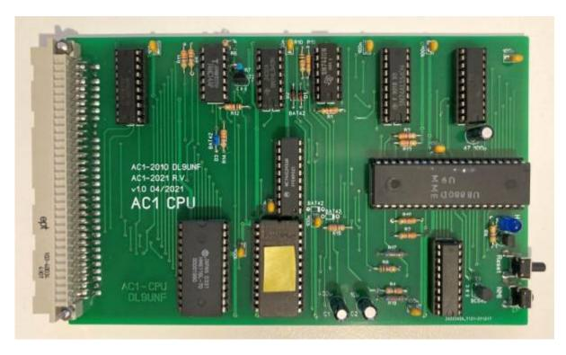
Auf der Karte ist eine CPU U880, der System-Monitor und ein kleiner statischer RAM enthalten. Es gibt Tasten für Reset und NMI.
