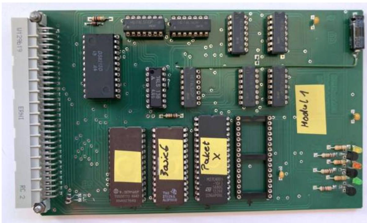
Auf der Karte sind 2 EPROMs und eine 1 MByte-EPROM-Bank. Die EPROMs blenden sich in den Adressraum des Systems ein: Bei Schreibzugriffen im Bereich 0-0FFF wird der „hinter“ dem System-ROM liegende, verdeckte RAM der 64K-RAM-Karte beschrieben.
