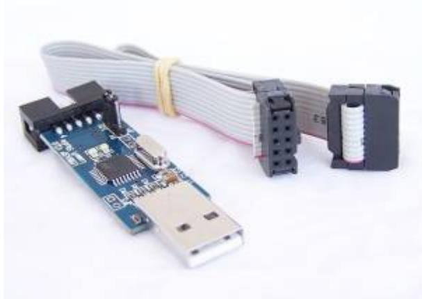
Ich hatte mir eine Version namens „USBASP V2.0 Lcsoft Studio“ gekauft. Bei Protostack findet man ein komplettes Userguide mit allen benötigten Unterlagen zu diesem Programmer (AC-PG-USBASP-UG-V2.0).pdf, s.u.).
