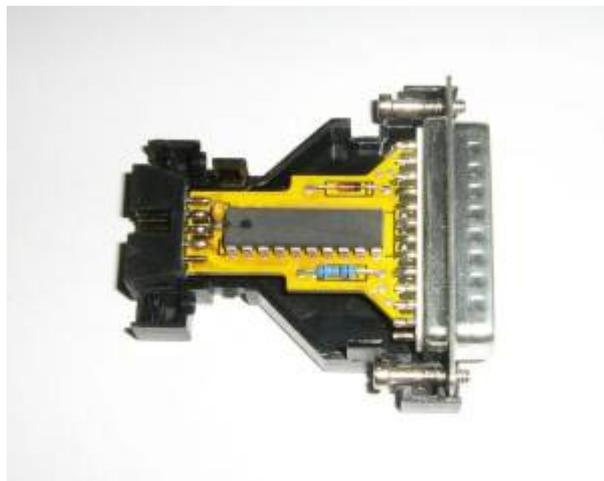
Dieser AVR-Programmieradapter (Bj 1998) wird am Parallelport angeschlossen. Er enthält lediglich einen 74HC244-Treiber-IC, die Programmierlogik übernimmt vollständig der PC. s.a.
