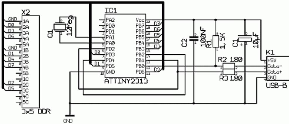
Von allen Möglichkeiten des USB-Interface wird in meiner Variante nur der I/O-Port (8 Datenleitungen) genutzt, die an die User-PIO1B des Z9001 angeschlossen werden.
