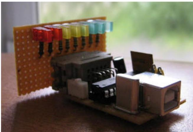
Auf einer Lochrasterplatte habe ich 8 LEDs nebst Vorwiderständen und einer 3x5poligen Buchse untergebracht (Für Nachbauer: die LEDs sind sinnvoller auf der anderen Leiterseite bzw. abgewinkelt anzubringen, so zeigen sie in Richtung USB-Kabel).
