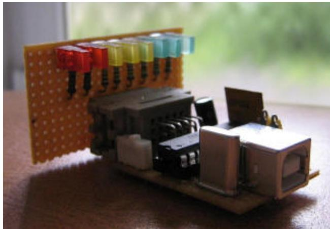
Auf einer Lochrasterplatte habe ich 8 LEDs nebst Vorwiderständen und einer 3x5poligen Buchse untergebracht (Für Nachbauer: die LEDs sind sinnvoller auf der anderen Leiterseite bzw. abgewinkelt anzubringen, so zeigen sie in Richtung USB-Kabel).
