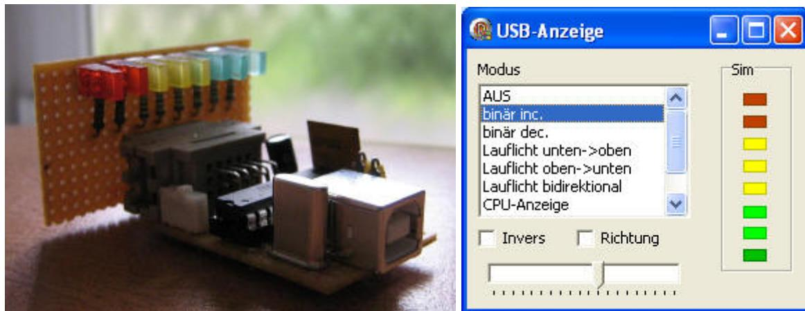
Auf einer Lochrasterplatte habe ich 8 LEDs nebst Vorwiderständen und einer 3x5poligen Buchse untergebracht (Für Nachbauer: die LEDs sind sinnvoller auf der anderen Leiterseite bzw. abgewinkelt anzubringen, so zeigen sie in Richtung USB-Kabel).
