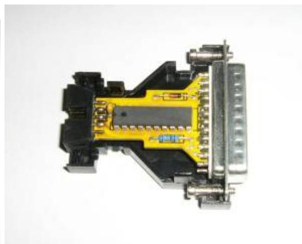
Dieser AVR-Progammiertreiber (Bj 1998) wird am Parallelport angeschlossen. Er enthält lediglich einen 74HC244-Treiber-IC, die Programmierlogik übernimmt vollständig der PC. s.a.
